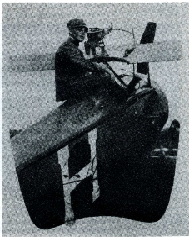
L'aviatore Aliperta. S. Caterina (Udine). Nieuport - Bébé da caccia. La mitragliatrice, una Levis, con caricatore circolare da 47 colpi, è sistemata fuori del giro dell'elica. La H che si intravede sulla carlinga era la sigla dell'Aliperta.
